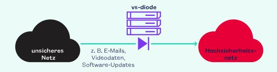
Transfer vom schwarzen ins rote Netz via vs-diode
