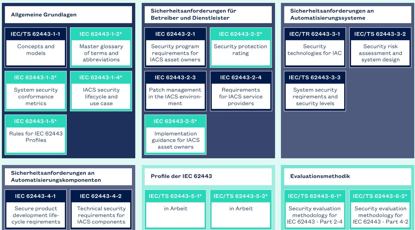
Bild 4: Aktuelle und geplante Dokumente zur Normenreihe IEC 62443 nach Angaben der IEC
